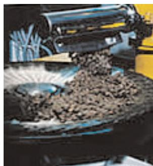
findet die restliche Trennung von Fruchtwasser und Öl statt. Auch bei der modernen Pressmethode darf nur dann „kaltextrahiert“ etikettiert werden, wenn beim Arbeitsprozess die Temperatur von 27°C nicht überschritten wird.
